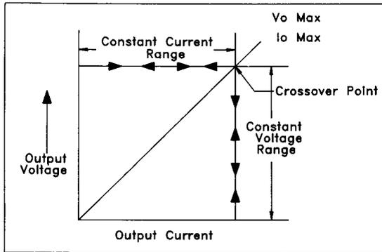
● 图 5-1 定电压/定电流特性
